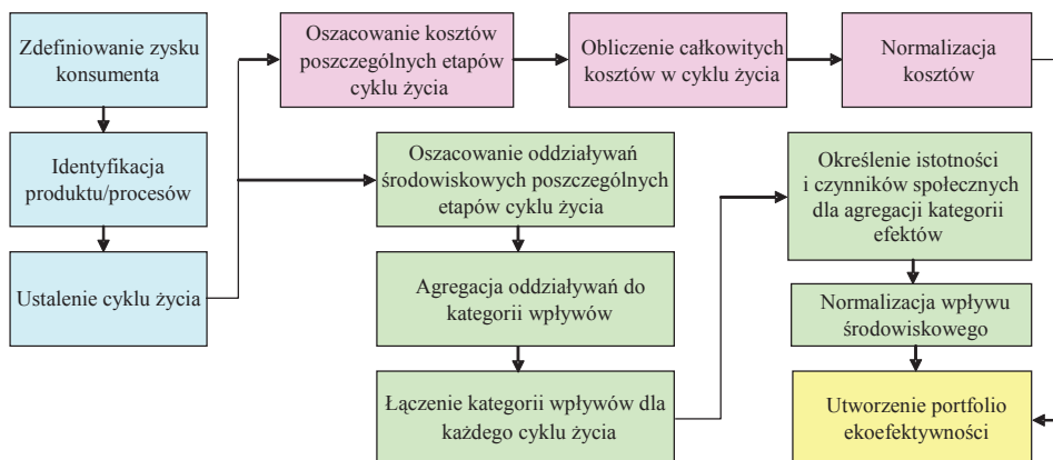
Rys. 1.1. Schemat działań w metodzie analizy ekoefektywności metodą EEA
