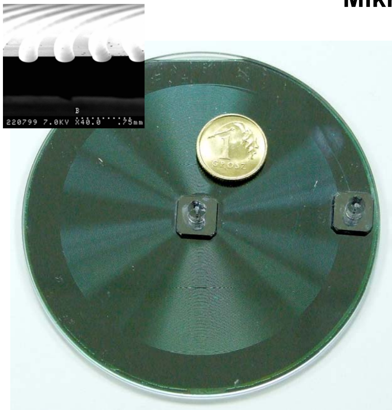
Mikrokolumna chromatograficzna gazowa, ID=150 \mu m, L=1,5 m
