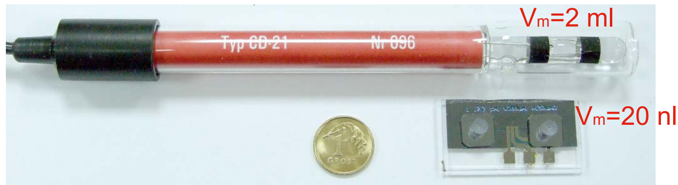
Mikroczujnik konduktometryczny w porównaniu do głowicy pomiarowej standardowego, makroskopowego czujnika
