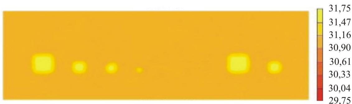
Rys. 4.15. Uzyskany numerycznie rozkład temperatury na powierzchni badanego materiału dla czasu stygnięcia 0,48 s [69].
