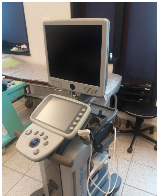
Rysunek 3.1 Skaner Ultrasonix Sonix Touch użyty do akwizycji danych oraz głowica liniowa L14-5/38.
