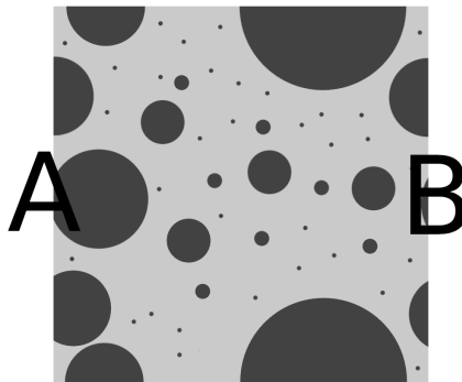
Rysunek 3.2: Schematyczna reprezentacja periodycznego położenia wtrąceń w elemencie.
