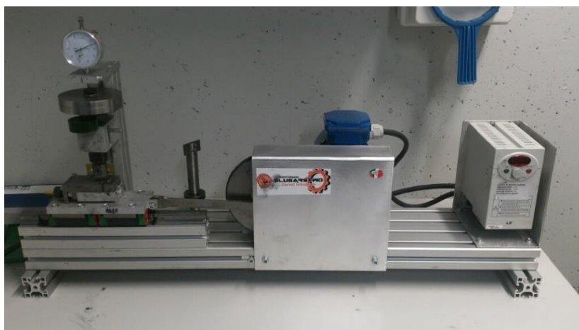
Rys. 14. Nacinarka do karbów wykorzystywana do przygotowania próbek SEVNB przy pomiarach odporności na kruche pękanie w czteropunktowym zginaniu (IPPT PAN).
