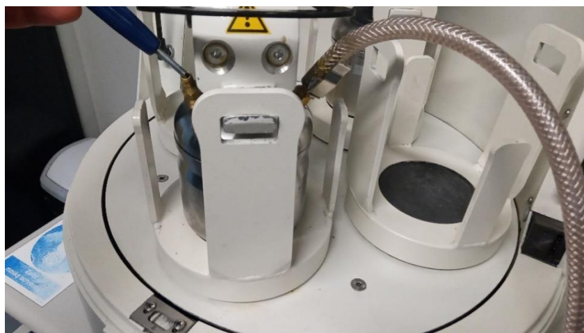
Rys. 17. Komora do mielenia proszków w atmosferze ochronnej. Fotografia przedstawia moment przedmuchiwania argonem wnętrza zamkniętej komory .
