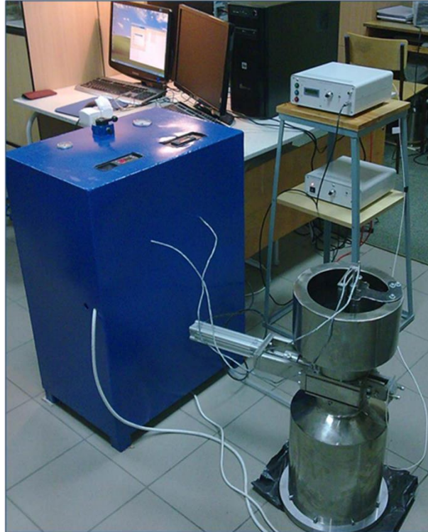
Rys. 25. Stanowisko badawcze do hartowania z przemianą izotermiczną w oleju hartowniczym.
