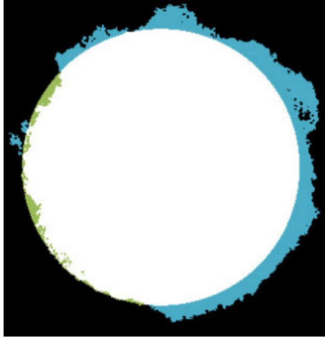
Rys. 3.40. Dwie nałożone na siebie mapy binarne przekroju promieniowego cylindrycznej objętości tkankowej o średnicy 5 mm zaplanowanej do ablacji i tej utworzonej wewnątrz badanej tkanki po jej wielokrotnej ekspozycji na wiązkę HIFU o częstotliwości 3.21 MHz. Wspólny obszar przekroju zaplanowanej i utworzonej zmiany nekrotycznej jest przedstawiony w kolorze białym. Niebieskim kolorem zaznaczono obszar nekrozy powstałej poza przekrojem zaplanowanym. Kolorem zielonym zaznaczono obszar zaplanowany do ablacji, który nie został pokryty nekrozą.
