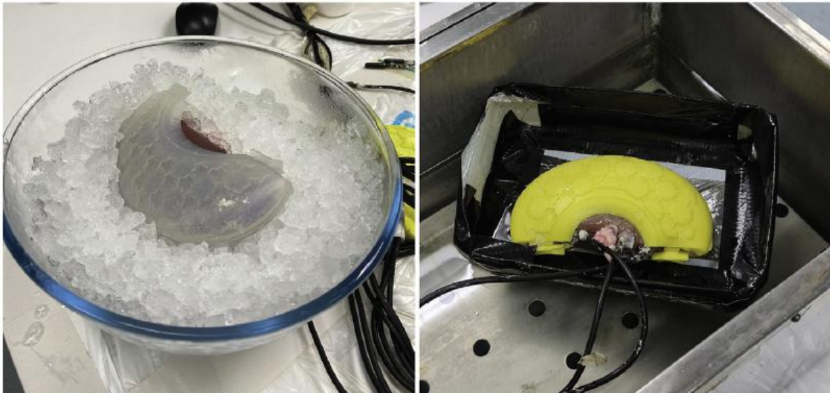
Rysunek II.27. Nakładka izolacyjna wykonana z silikonu (biała), nakładka izolacyjna wykonana z poliuretanu (żółta), Khan 2021.
