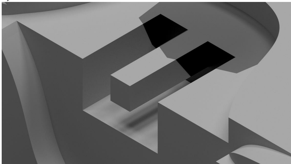
Rys. 8. Schemat wytworzonej belki dla kompozytu z cząstkami 20 \mu\text{m} .
