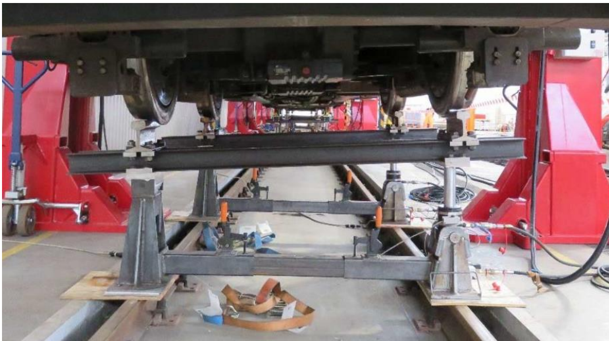
Rys. 3.4. Przenośne stanowisko badawcze do pomiaru odciążenia kół wózka.
