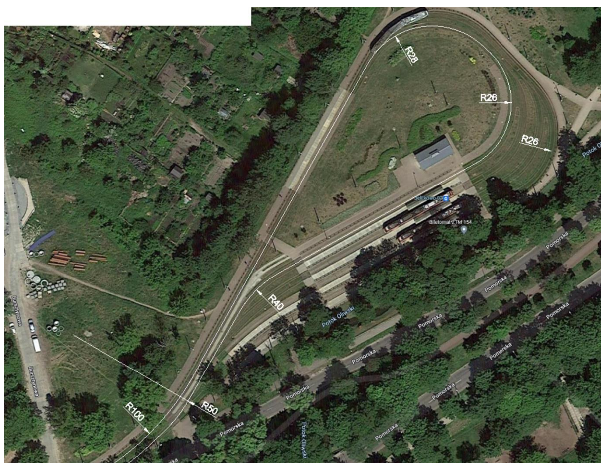
Rys. 7.8. Kształt geometryczny pętli Jelitkowo
