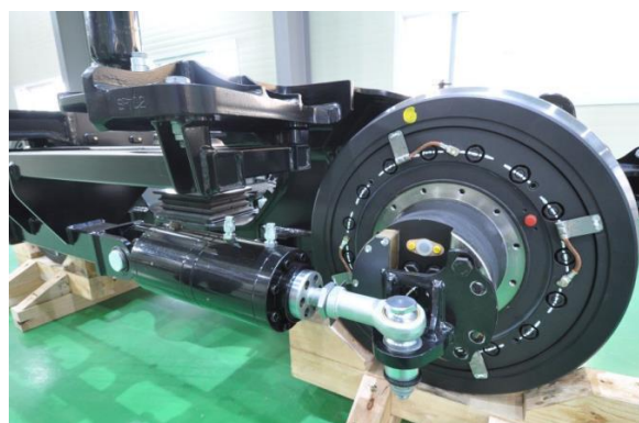
Rys. 4.23. Wózek toczny Hyundai Rotem z niezależnie obracającymi się kołami. Widok od czoła (a) oraz widok na siłownik hydrauliczny łączący zestaw kołowy z ramą wózka (b) [2].
