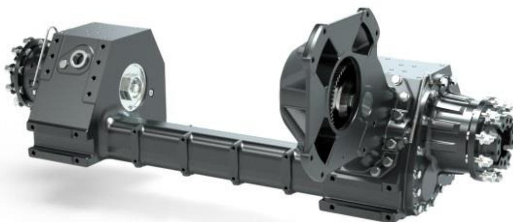
Rys. 4.27. Przekładnia w portalu zestawu kołowego z niezależnie obracającymi się kołami wózka Alstom Arpège [62].
