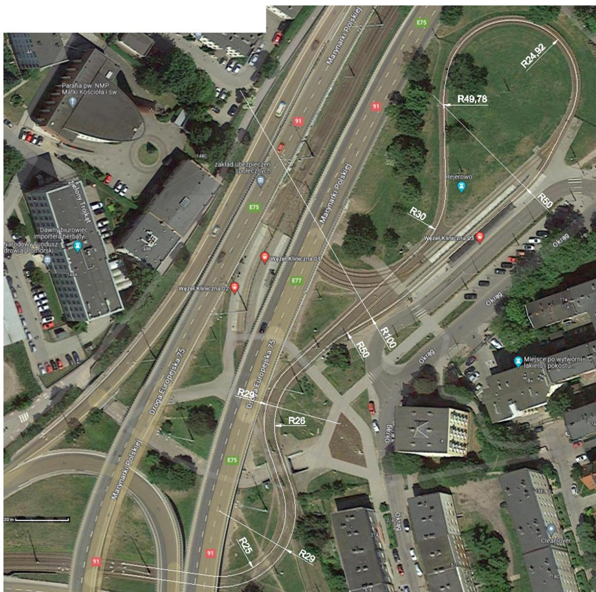
Rys. 7.10. Kształt geometryczny pętli Kliniczna
