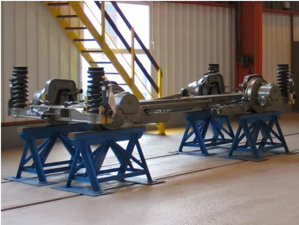
Rys. 4.8. Widok układu jezdny tramwaju Cobra gotowego do wbudowania w wagonie [19].
