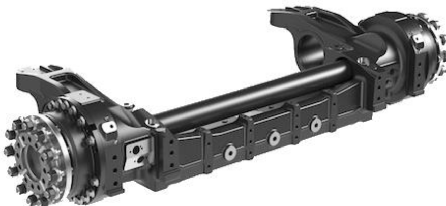
Rys. 4.34. Element główny zestawu kołowego wózka Alstom Iponam [62].
