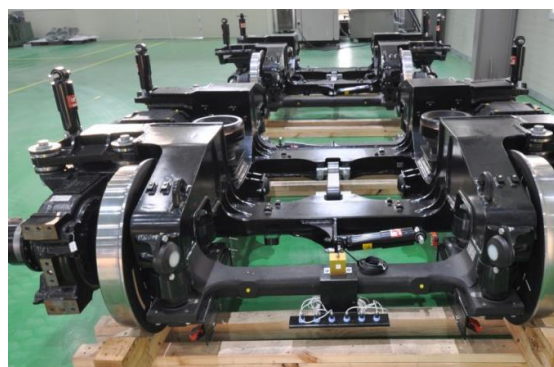
Rys. 4.21. Wózek napędowy tramwaju Hyundai Rotem z niezależnie napędzanymi kołami – widok z boku (a) oraz od czoła (b) [2].
