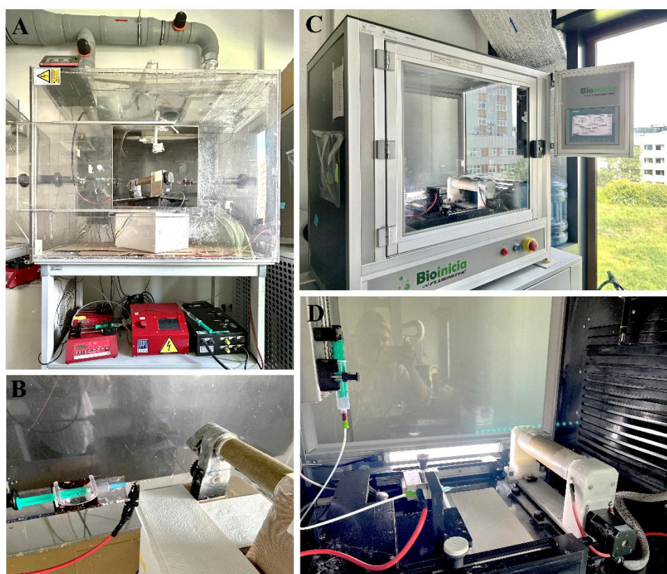
Rys. 7. Komory do elektroprzędzenia wykorzystywane w pracach w niniejszej rozprawie: A i B – samodzielnie wykonana, C i D – komora LE-50 Fluidnatek z regulacją temperatury i wilgotności firmy Bioinicia.
