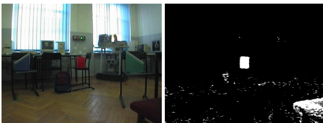
Rysunek 7.10: Przykład wykrywania wszystkich piksli o określonej barwie w obrazie z zakłóceniami
