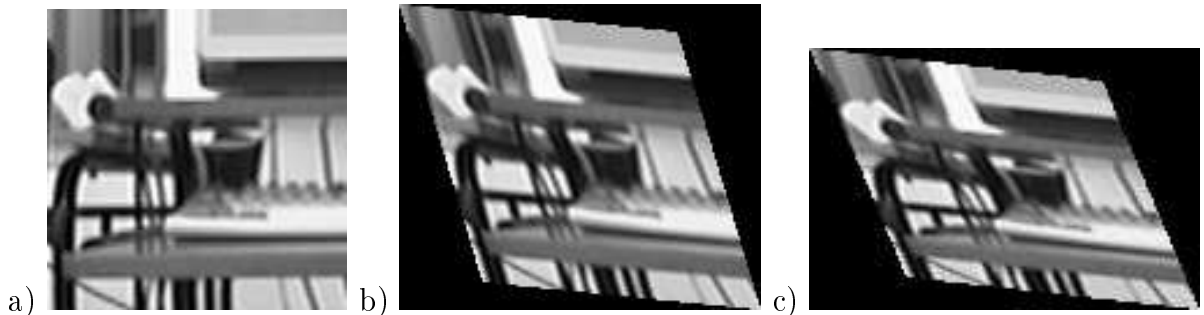
Rysunek 3.7: Przykłady transformacji afinicznej: a) obraz przed transformacją; b) i c) – transformacja obrazu
