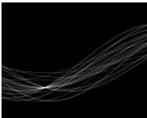
Rysunek 3.15: Obraz transformaty Hougha obrazu z rysunku 3.14
