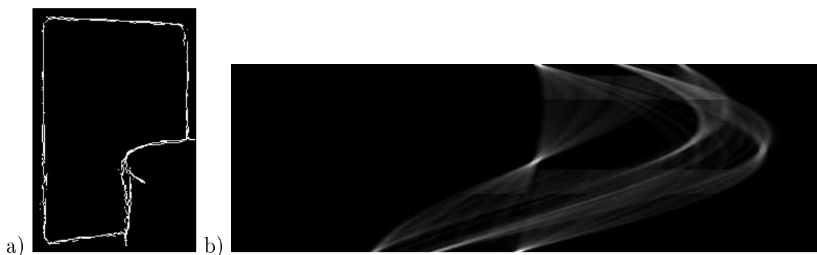
Rysunek 7.23: Transformata Hougha fragmentu obrazu z zakłóconym prostokątem: a) obraz wejściowy; b) obraz transformaty Hougha tego obrazu
