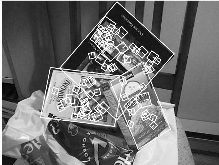
Rysunek 5.1: Przykład detekcji fragmentów przedmiotów metodą SIFT oraz identyfikacji przedmiotów
