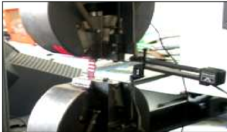
Rys. 73. Widok zamocowanej próbki NiTi w szczękach maszyny wytrzymałościowej INSTRON 5867 (a); próbka NiTi podczas testu na rozciąganie z zastosowaniem bezdotykowego ekstensometru laserowego (b).
