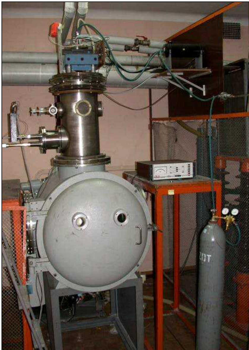
Rys. 15. Widok ogólny implantera IMJON-1, IPPT
