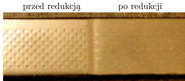
Rysunek 7.5: Zmodyfikowana mechanicznie powierzchnia blachy.
