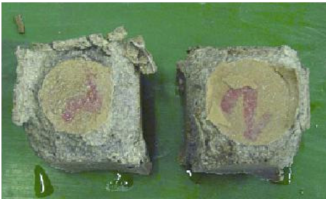
Rysunek 1.4. Zaawansowane zniszczenie próbki wykonanej z zaprawy cementowej o stosunku w/c=0.45 pod wpływem Na_2SO_4 o stężeniu 5%. Czas ekspozycji na działanie siarczanów – 510 dni (rysunek reprodukowany z pracy Lee, S.T.; Moon, H.Y.; Swamy, R.N. Cement and Concrete Composites , 27, 65-76, 2005 – za zgodą Wydawcy czasopisma).
