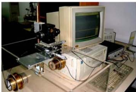
Rys.3.4.4 Wanna pomiarowa z przetwornikami, pozycjonerem próbki, komputerem sterującym i układem nadawczo-odbiorczym
