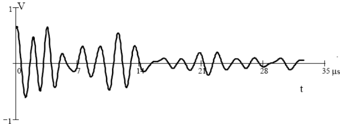
Rys.3.3.10 Sygnał o częstotliwości środkowej 0,58MHz rozproszony w kości gąbczastej. Przedstawiony został tylko wybrany obszar pomiarowy.
