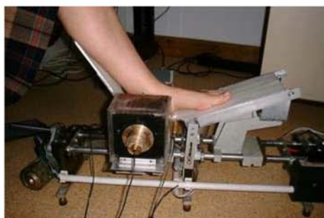
Rys.3.4.5 Układ do pomiarów in vivo - układ do pozycjonowania wraz ze znacznikiem laserowym.
