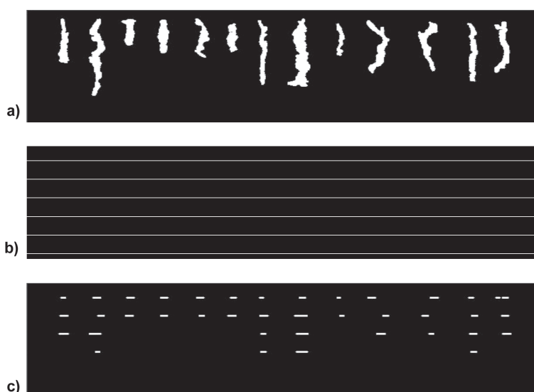
Rys.14. Ilustracja sposobu określania rozkładu szerokości rys (c) w wyniku logicznego iloczynu obrazu uszeregowanych rys (a) i obrazu układu linii (b)
