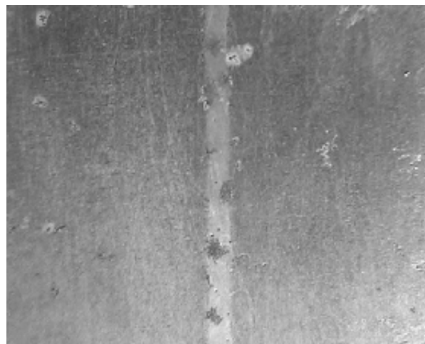
Rys. 3. Powierzchnia próbki ze złączem AZ91 + AZ91 po próbie potencjostatycznej
