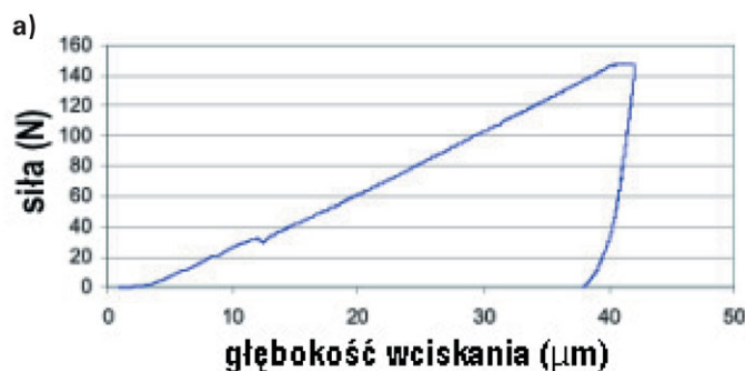
Rys. 9. Próba wciskania: a) siła w funkcji głębokości wciskania, b) odcisk wgłębnika
