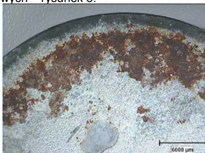
Rys. 5. Obraz powierzchni elektrody zdegradowanego warystora ZnO w powiększeniu 5x
