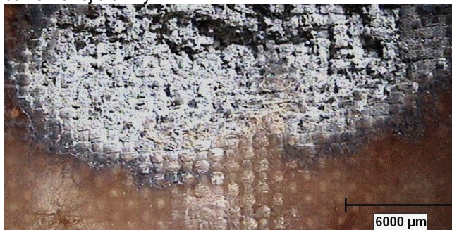
Rys. 18. Powiększony obraz fragmentu dolnej powierzchni płytki tekstolitowej o najsilniejszym stopniu degradacji. Zwęgleniu uległa żywica fenolowa oraz kilka warstw bawełnianej tkaniny
