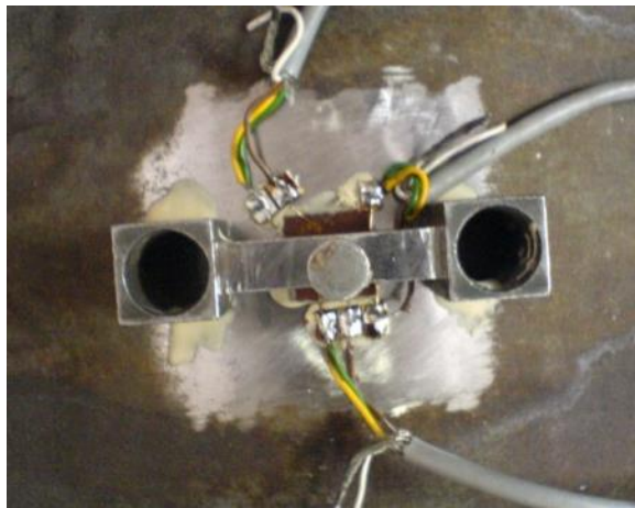
Rys. 20. Ilustracja przygotowanego do badań zespołu pomiarowego po wykonaniu niezbędnych połączeń lutowanych
