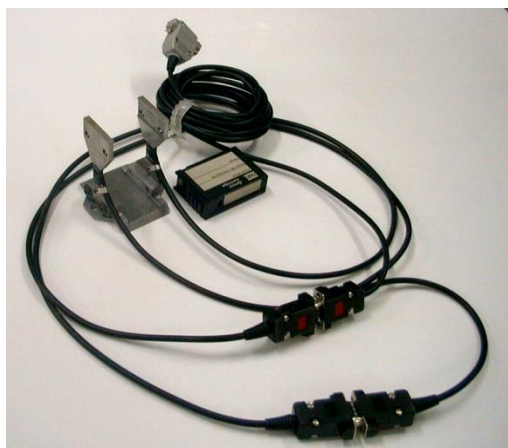
Rys. 9. Czujnik do pomiaru siły tarcia (a); kontroler maszyny wytrzymałościowej (b)
