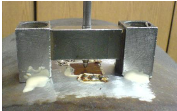
Rys. 19. Ilustracja przymocowanej do badanej rury przewodnicy freza
