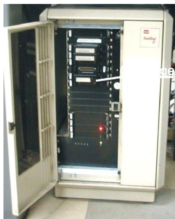
Rys. 9. Czujnik do pomiaru siły tarcia (a); kontroler maszyny wytrzymałościowej (b)
