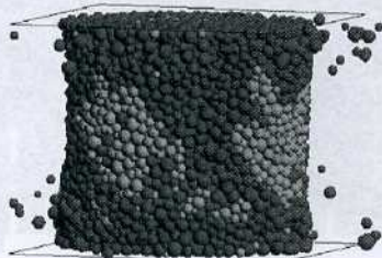
Rys. 1. Symulacja próby jednoosiowego ściskania próbki skały metodą elementów dyskretnych
