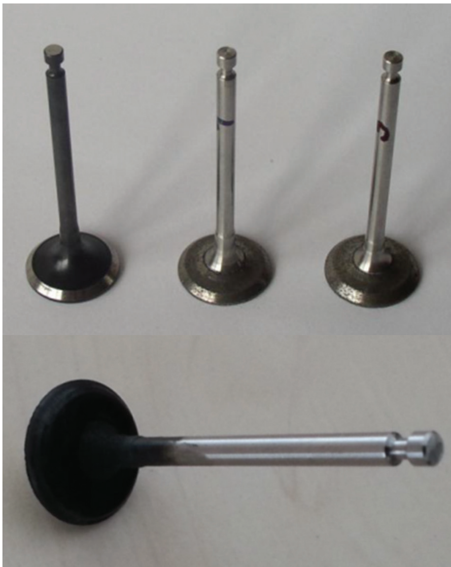
Rys. 1. Przykładowy wynik prac B+R uzyskany w ramach projektu 7. PR UE MATRANS koordynowanego przez KMM-VIN: Zawór silnika spalinowego (zdjęcie na dole) wykonany z kompozytu gradientowego \text{NiAl}/\text{Al}_2\text{O}_3 (20% redukcji ciężaru w porównaniu do zaworów tradycyjnych)
