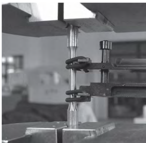
Rys. 3. Mini-próbka zamocowana w maszynie wytrzymałościowej wraz z ekstensometrem
