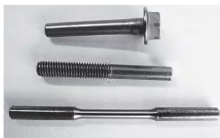
Rys. 2. Zdjęcie dwóch połówek śruby M5×140 po obróbce mechanicznej, oraz wytworzonej z niej próbki do rozciągania
