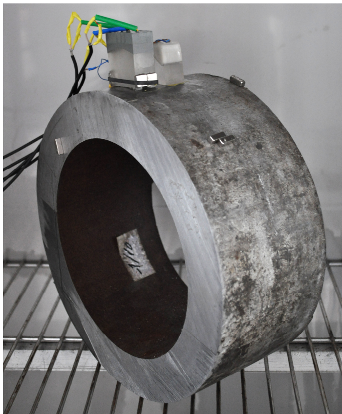
Rys. 6. Próbką wycięta z rurociągu. Średnica zewnętrzna 273mm, grubość ścianki 40mm.
