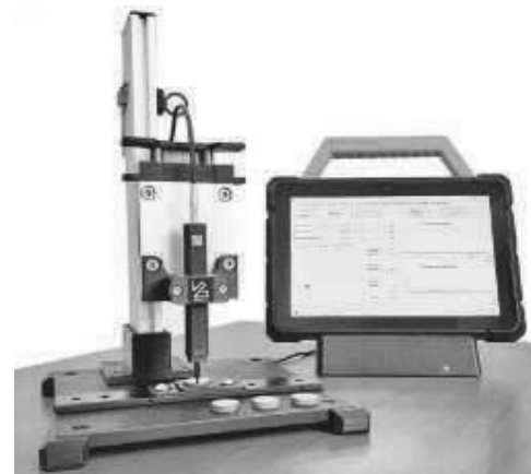
Rys. 1. Stanowisko pomiarowe do nieniszcząca ocena grubości przypowierzchniowej warstwy azotków.
