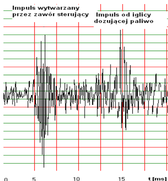
Rys. 7. Przykładowy przebieg czasowy sygnału generowanego we wtryskiwaczu.
