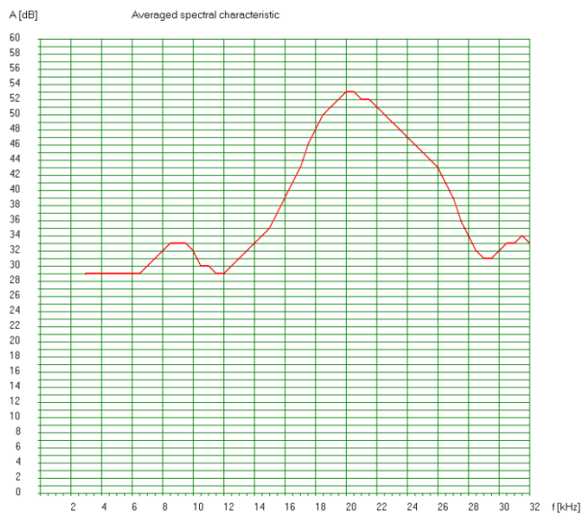
Rysunek 15. Wynik działania procedury uśredniającej charakterystykę aktywności wtryskiwacza. Przeanalizowano 10 jednosekundowych zapisów pracy wtryskiwacza sprawnego, przedstawianego na rysunku 13.
