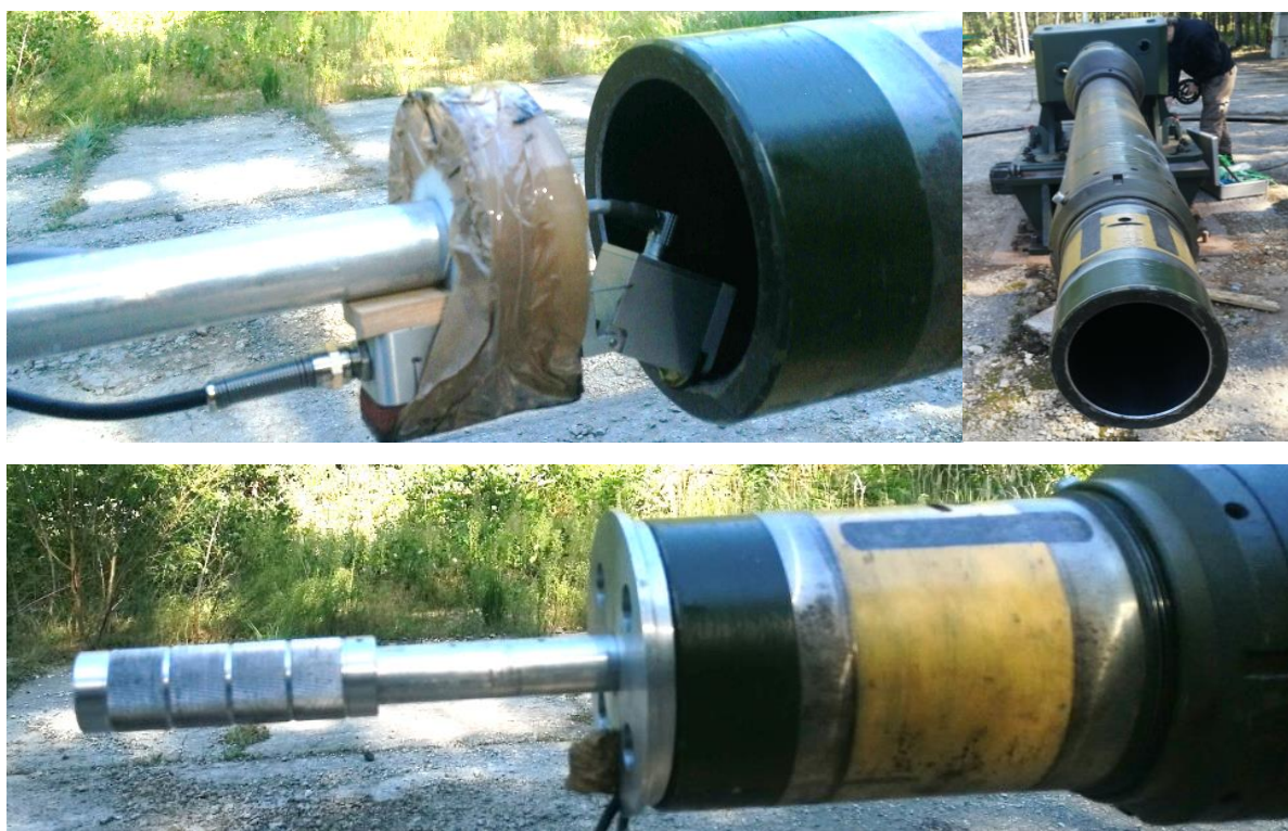
Rys. 11. Zdjęcia skanera zintegrowanego z głowicą ECA w czasie badań lufy
