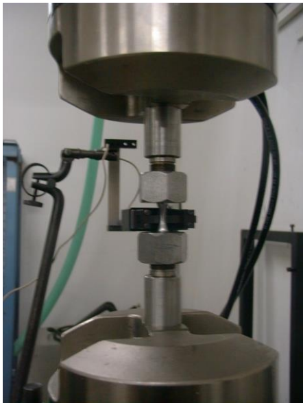
Rys. 19a. Fotografia próbki, sposobu zamocowania i miejsca pomiaru zmiany średnicy
